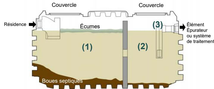
Ce qui est retenu dans la première section (1) ne doit pas se retrouver plus loin dans le système, sinon il y a possibilité de colmatage prématuré du champ d'épuration (élément épurateur), du puits absorbant et/ou du système de traitement.
