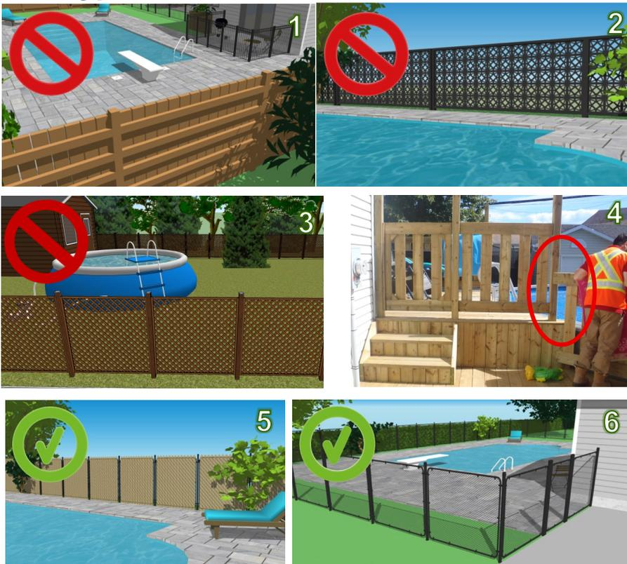
1. Cette enceinte n'est pas conforme, car les travers horizontaux sont trop rapprochés et pourraient permettre à un enfant d'escalader la clôture.
